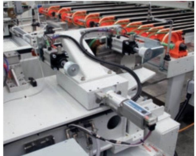
Le réglage automatique de la ligne de référence pour l'enlèvement de matière en fonction de l'épaisseur évite les interventions manuelles de l'opérateur.
