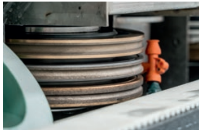
Fiabilité maximale grâce à la disponibilité de la version à 4 meules superposées permettant de changer rapidement l'épaisseur du volume à façonner.
